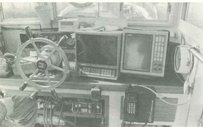
▲漁船のコクピット。無線、電話、魚群探知機、自分の位置を示す機器などが並ぶ。
